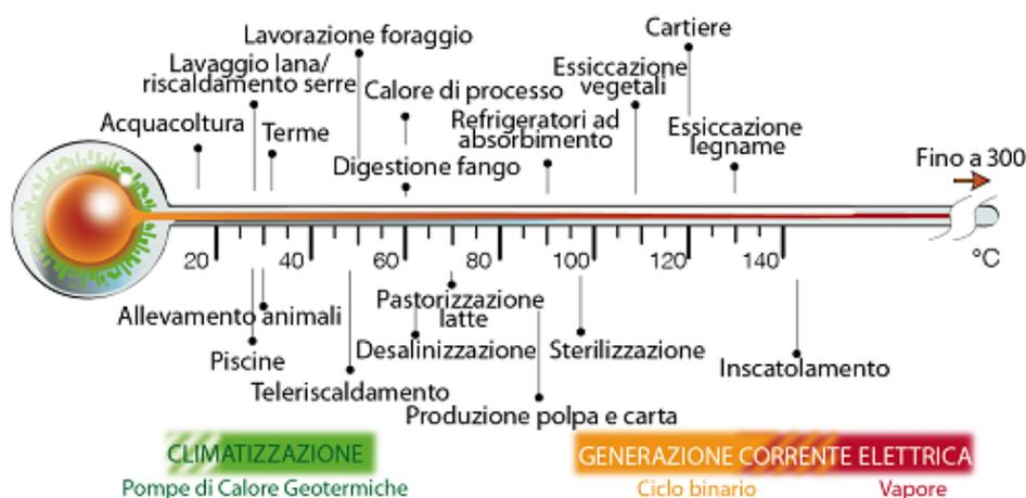
Figura 1: Possibili usi dell'energia geotermica, in base alla temperatura dei fluidi disponibili [4]
