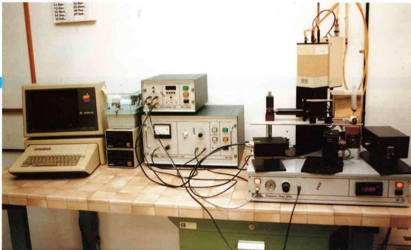
3 - Spettrofluorimetro a flusso interrotto per la misura di cinetiche veloci applicato al trasporto molecolare attraverso le cellule.
