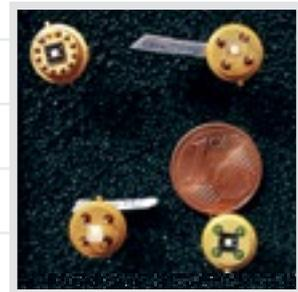
Presso FBK abbiamo poi separato i singoli chip e li abbiamo montati su supporti specifici (package). Il sensore era così pronto per essere testato in camera di test in presenza di aria con concentrazioni note di inquinanti (per esempio ossido di carbonio, CO).
